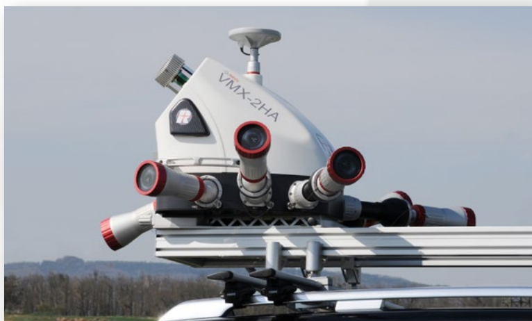
VMX-2HA配备7个球关节定向的RIEGL相机
