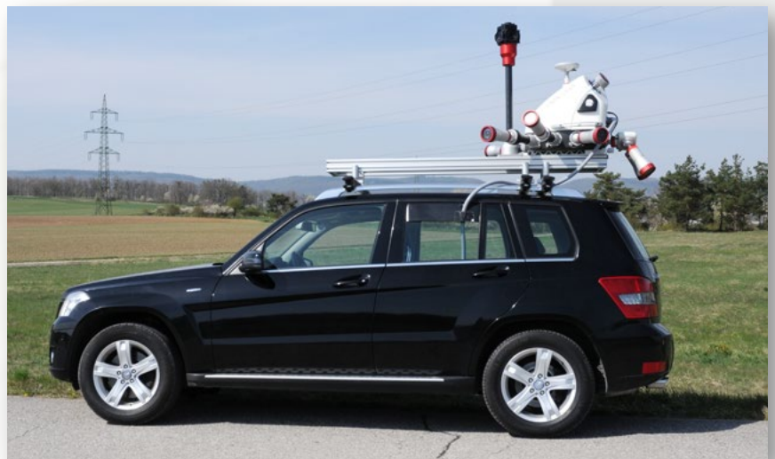
RIEGL VMX-2HA 系统通过 VMX-2RM 加强型顶部支架安装
