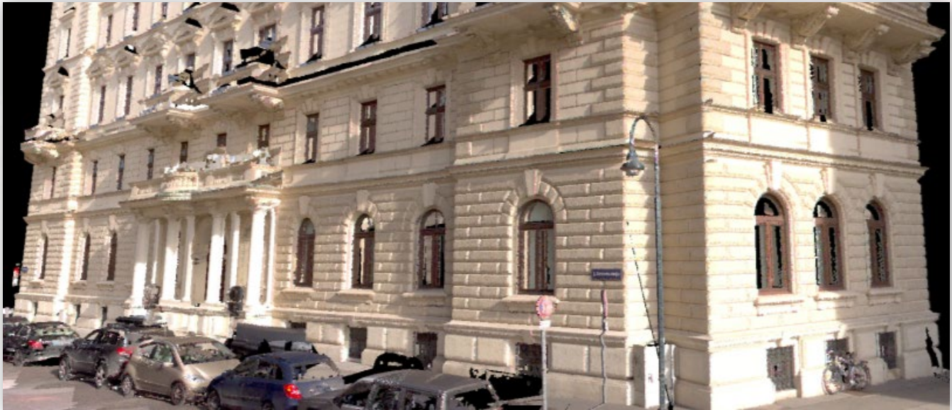
真彩色点云: 图像数据由 FLIR Ladybug 5+ 提供
