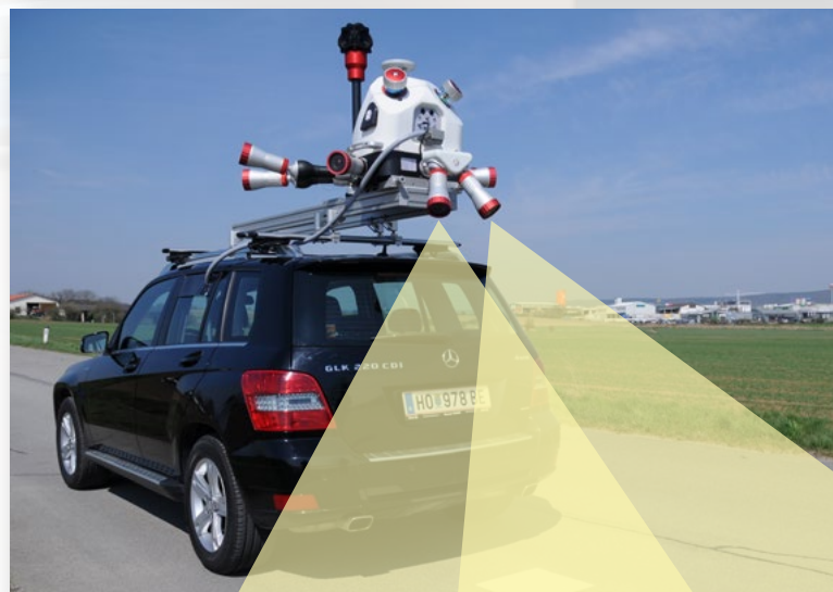
VMX-2HA配备6个RIEGL的侧方相机, 2个下视路面相机和一个Ladybug 5+全景相机
